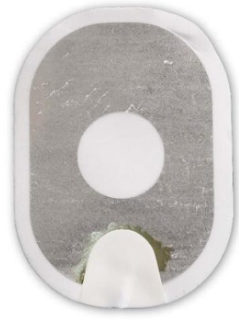
Afbeelding 3: de gel heeft bijna volledig losgelaten van de achterkant.
